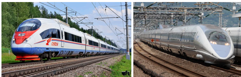
Рис. 1. Слева — «Сапсан» с коротким обтекаемым носом, справа — синкансэ́н серии 500 с вытянутым «клювом». Фото: Sergey Korovkin 84, CC BY-SA 3.0; JobanLineE531, CC BY 3.0; Wikimedia Commons.
