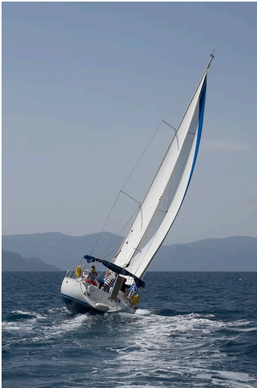
Рис. 1. Яхта идёт круто к ветру: паруса выбраны почти в диаметральной плоскости, корпус накрён. Боковую силу гасит киль, а вперёд остаётся тяга. Фото: Katsiaryna Naliuka, CC BY-SA 4.0, Wikimedia Commons.
